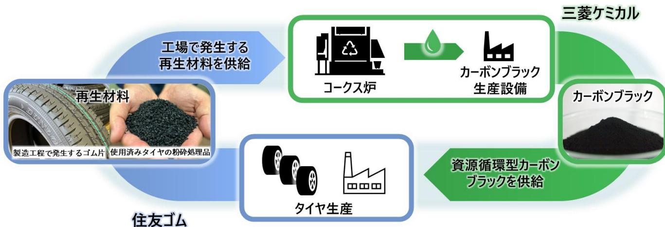
今回の協業で、住友ゴムはタイヤの製造工程で発生するゴム片および使用済みタイヤの粉碎処理品（再生材料）を三菱ケミカルに供給します。三菱ケミカルはそれらの再生材料を原料の一部としてコークス炉に投入してケミカルリサイクルを行い※1、得られたタルルからカーボンブラックを生産します。できあがった資源循環型カーボンブラックは住友ゴムが生産するタイヤの原料として使用されます。
